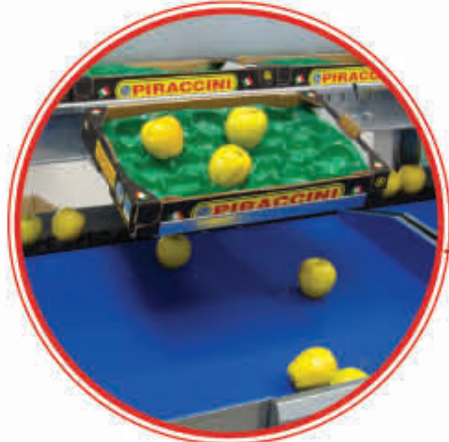
SISTEMA DE DESCARGA Y DE ENVASADO
