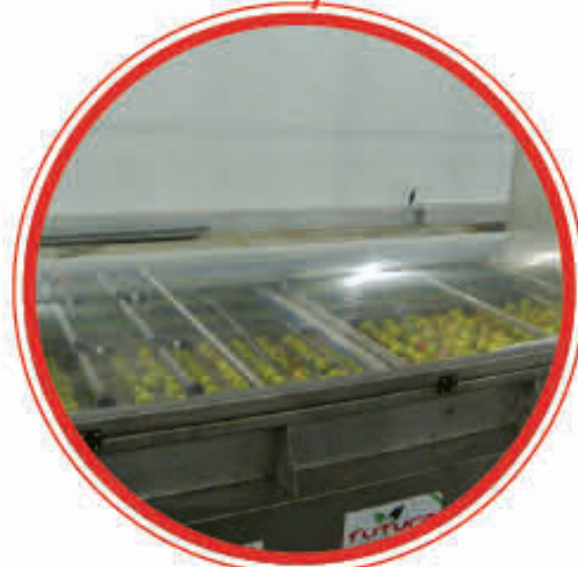
SISTEMA DE CEPILLADO, LAVADO Y SECADO
